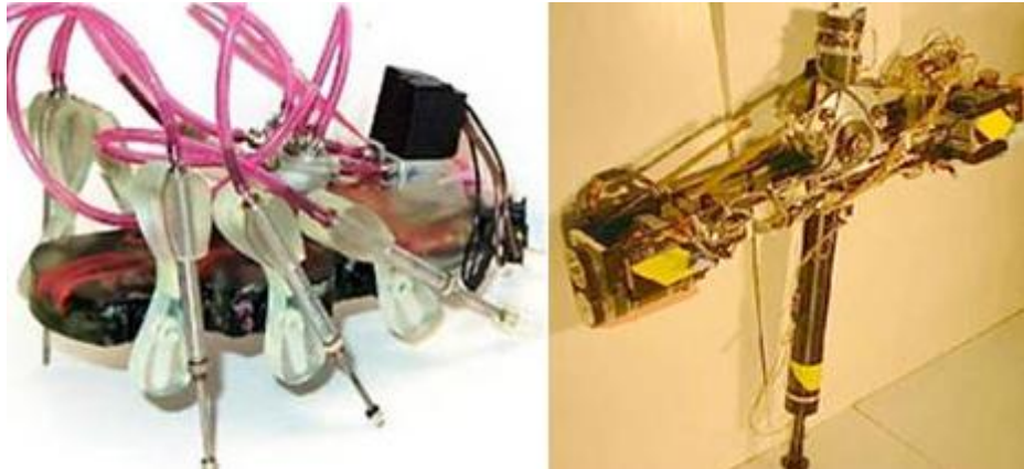
Նկ. 174. Ռոբոտներ որոնք ստեղծվել են Ստենֆորդի համալսարանում 1- Վեցոտանի ռոբոտ, 2-մոնոպոդ ռոբոտ
